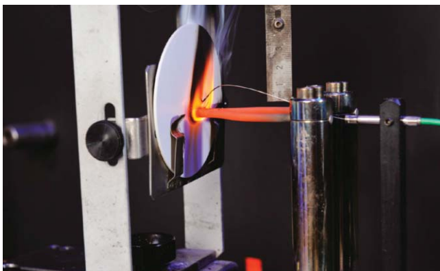
Izzóhuzalos éghetőségi termékvizsgálat a Lanxess laboratóriumában.
