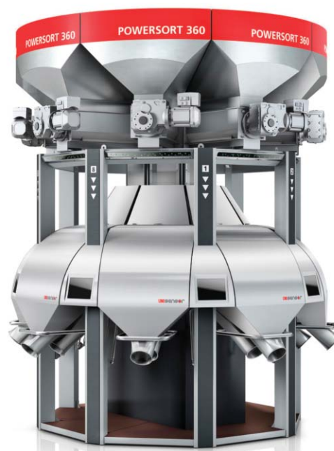
Az Unisensor Powersort 360 intenzív lézersugárral gerjeszti és analizálja a műanyag molekuláit.
