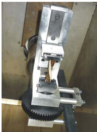
3. ábra. Szakítógépre szerelhető egyedi csavaró befogó egy 180°-ban megcsavart, (eredetileg) téglalap keresztmetszetű próbatesttel. A fogaskerék átmérője 90 mm
