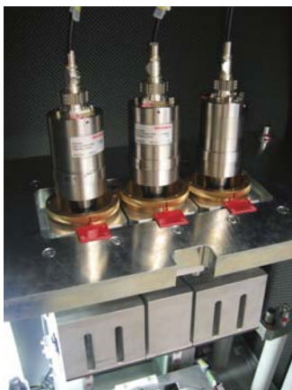
4. ábra. Szonotródák merev befogási technikája
