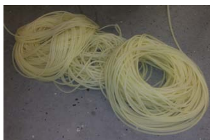
2. ábra. Extrúzióval folytonosan előállított TPS előgyártmány
