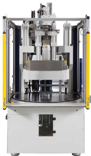
4. ábra. CM-R 40 függőleges fröccsöntő gép – minden oldalról szabadon hozzáférhető
