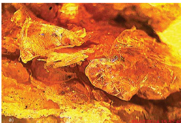
1. ábra. Brabender Plasticorder-ben kevert PP, PET és PE polimer, a) adalékanyag nélkül, b) 1,5% Ken-React CAPS KPR 12/LV kompatibilizáló szerrel
