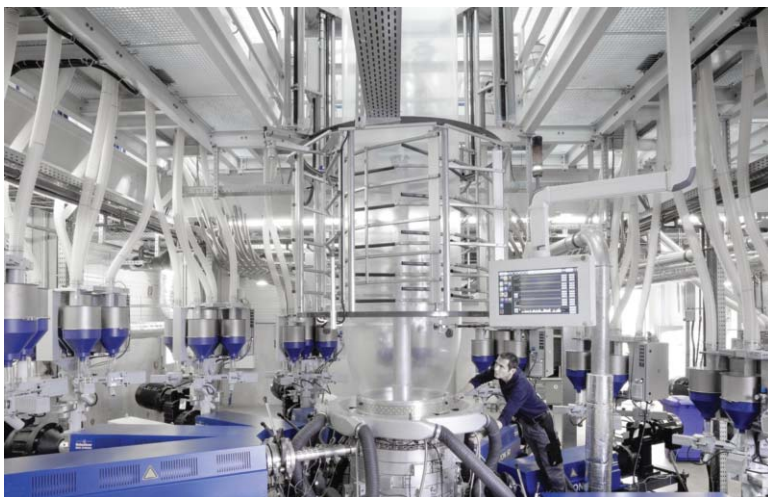
6. ábra. A Reifenhäuser Evolution Ultra Die rendszerrel nagy rugalmasság érhető el a zárófóliák gyártásában
