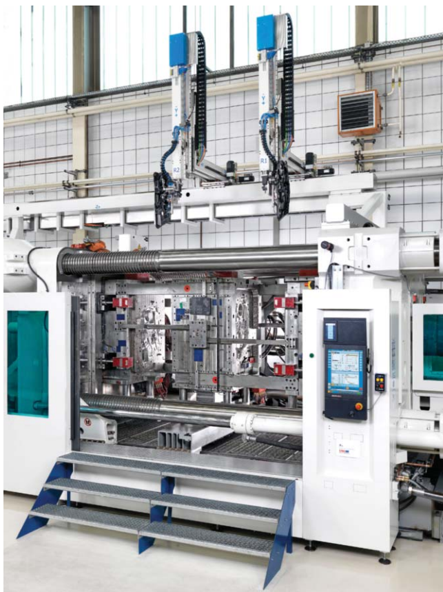
A fröccsöntő gépen elhelyezett KraussMaffei LRX TwinZ robot
