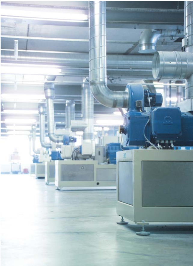
Feddem kompaundextruderek az Akro-Plastic üzemében
