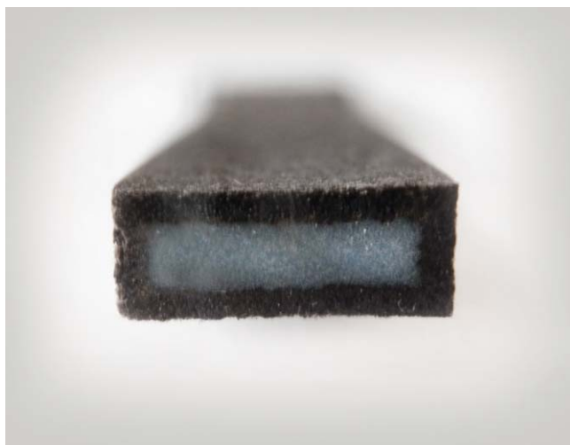
4. ábra. AKROMID® C3 GF 30 1 natúr anyagú mintarúd 700 órás, 210 °C hőmérsékletű öregítés után (AKRO-PLASTIC)
