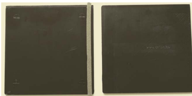
2. ábra. Ragasztott kötés tisztán adhéziós tönkremenetellel (megjegyzés: az ábrán tönkremenetel után a jobboldali lapka megfordítva látható, így szemléltetve, hogy a ragasztószalag a jobboldali lapkáról teljesen levált)
