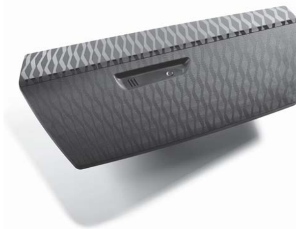
Egy hidraulikus Allrounder 630 S gép kb. 60 s ciklusidővel, ProFoam eljárással gyártja ezt a struktúrált felületű fedelet (Cég: Covestro) autó belsőterbe (Foto: Arburg)
