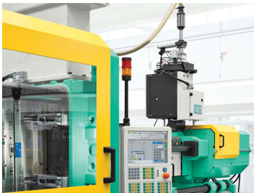
Az új 5 literes granulátumzsilip az Arburg-tól 1300-tól 4600-as fröccsegység méretig kiterjeszti a ProFoam spektrumát a nagyobb alkatrészek gyártásában
