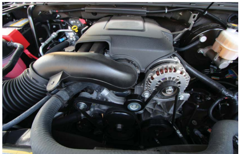
A Chemlon keverékből készült motorburkolat extrém körülményeknek, köztük magas hőmérsékletnek, állandó rezgéseknek és vegyi folyadékoknak van kitéve
