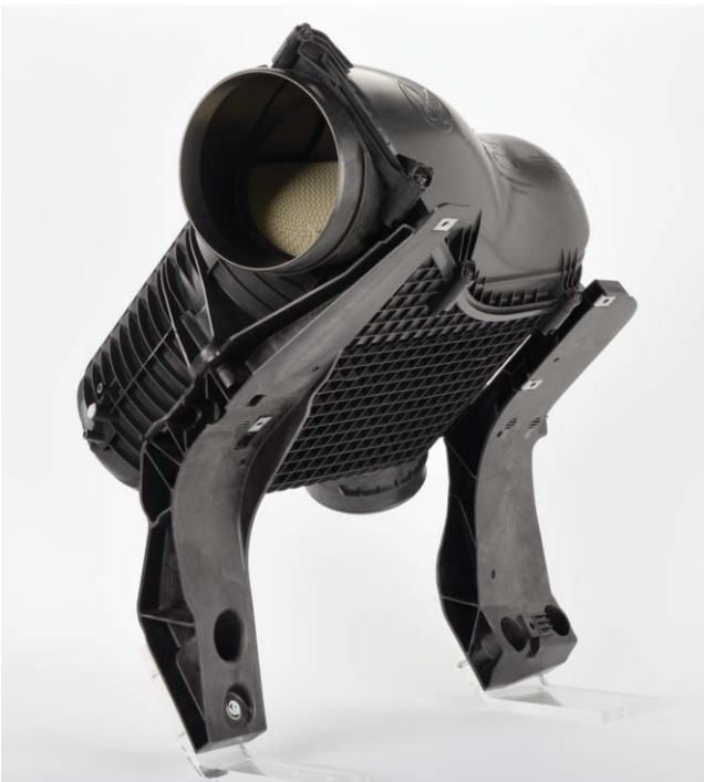
Lanxess Durethan AKV 50 H2.0 üvegszál erősítésű poliamidból készült teherautó légszűrő hordozó
