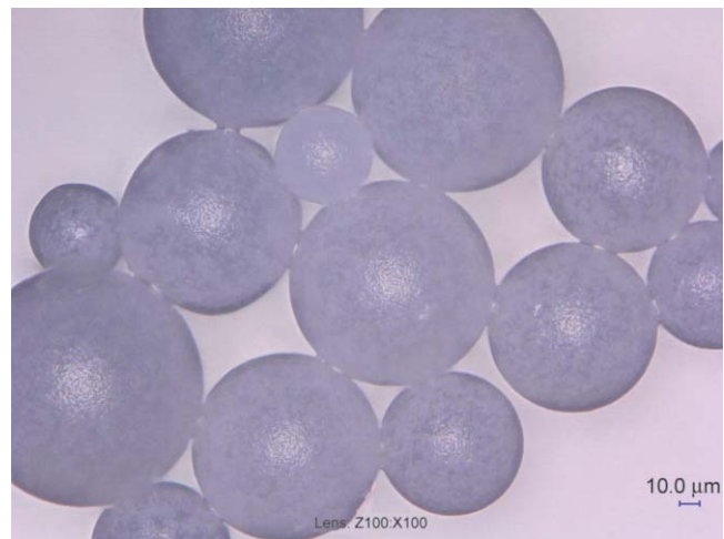
2. ábra. Az emulzióból szuszpenzióvá konvertált tömbfázisban megtalálható PHB szemcsék digitális optikai mikroszkópi képe
