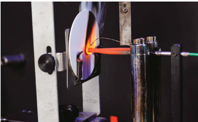
Izzóhuzalos éghetőségi termékvizsgálat a Lanxess laboratóriumában.
