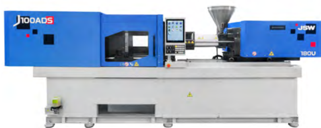
△ A 100 tonnás záróerejű, kis méretű elektromos fröccsöntőgép is nagy pontosságú öntésre képes
