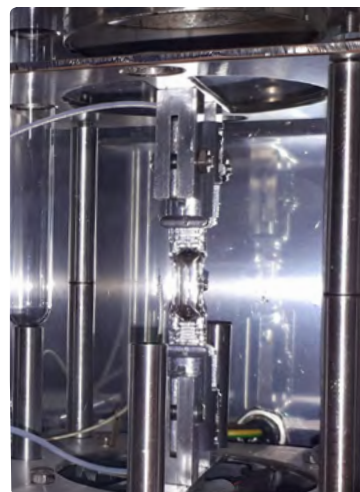
2. ábra. A kémcsőbe helyezett gyantaminták UV-térhálósítására szolgáló egyedi készülék
