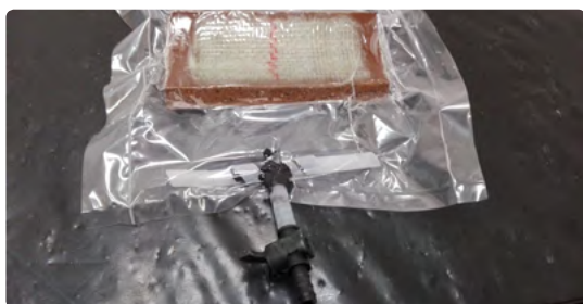
5. ábra. Vákuumozott, térhálósításra előkészített csőszegmens
