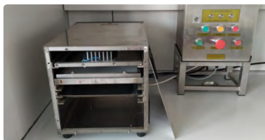
6. ábra. A packer térhálósító hatását modellező, saját fejlesztésű laboratóriumi készülék
