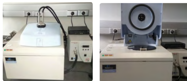
3. ábra. A Polinvent Kft. foto-DSC műszeregyüttese balra zárt, jobbra nyitott állapotban
