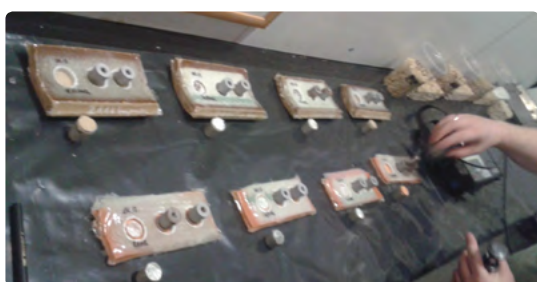
7. ábra. Tapadószilárdság mérése kőagyag csőszegmenseken
