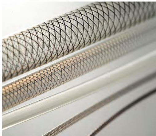
△ Extrudálással gyártott orvostechnikai cső katéterekhez, amely két polimer réteg között fém- vagy műanyag szálas fonatot tartalmaz erősítés céljából
