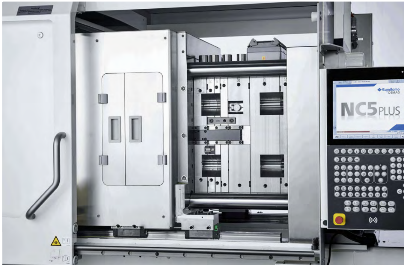
△ Az IntElect2 180 S típusú gép megnövelt oszloptávolsággal nagyobb felhasználási flexibilitást nyújt
