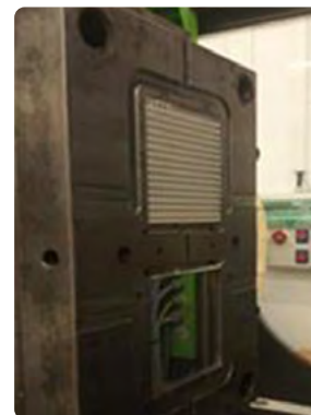
2. ábra: A fröccsöntő szerszám a behelyezett vázszerkezettel
