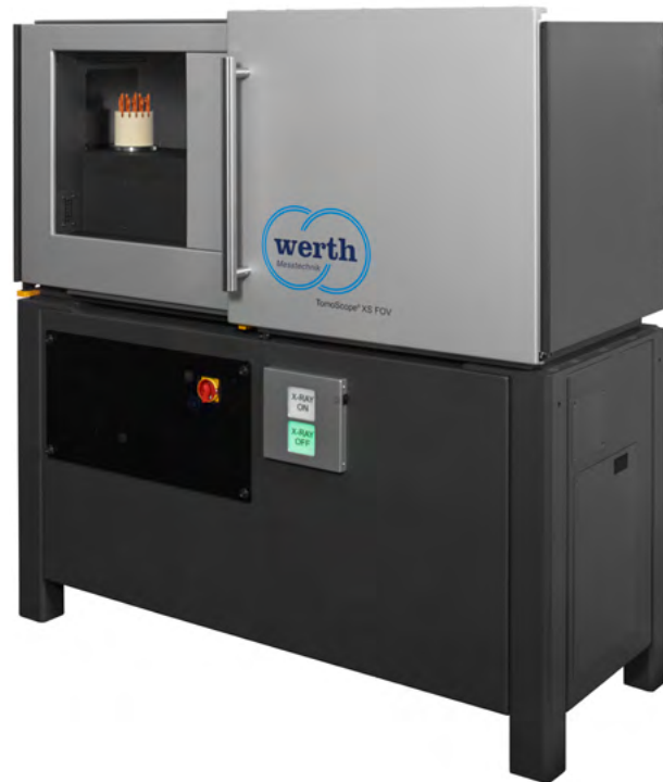
△ Werth TomoScope®XS FOV nagy teljesítményű, rendkívül pontos, CT elven működő koordináta mérőgép
