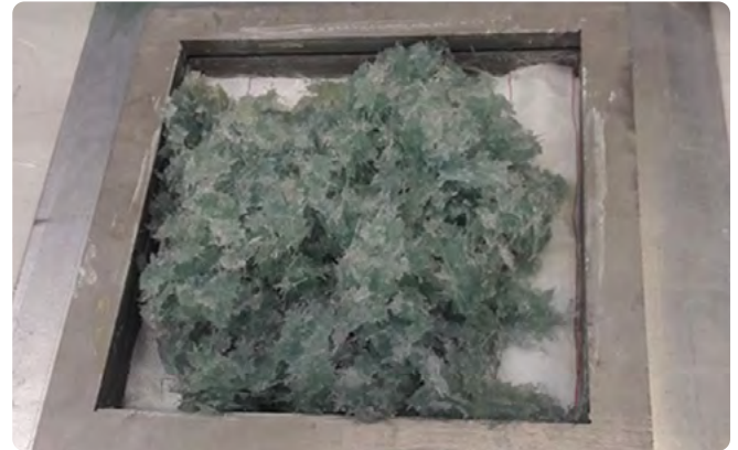
3. ábra: Kompozit készítés az őrleményből. A lemezeket nyomás alatt, 2 órán keresztül 80 °C hőmérsékleten tartottuk
