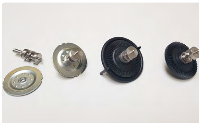
△ Balról jobbra: kétrészes fémbetét (mely a tengelyből és a tárcsából áll), szórt munkadarab, kész alkatrész
