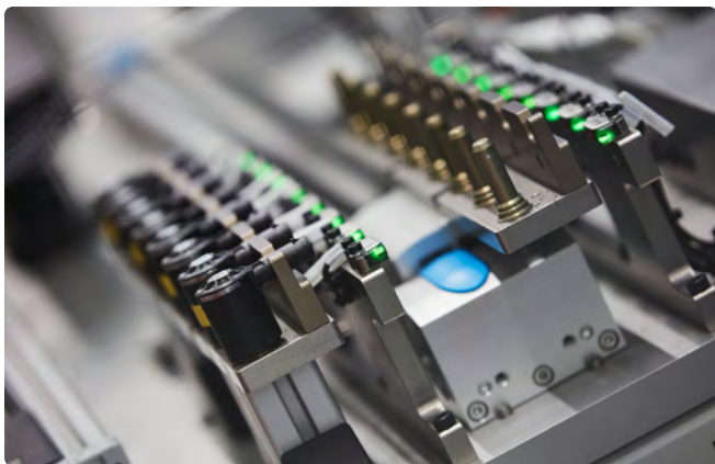
△ A körbefröccsöntött elektromos tekercsüket 100%-ban inline ellenőrzik (kép: Arburg)
