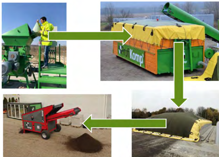
△ A ProfiKomp komposztálási technológia folyamata: 1. mechanikai előkezelés aprítóberendezéssel, 2. átmeneti mobil kezelőkonténer, 3. takart, levegőztetett, silós rendszerű komposztáló (8 hét 80°C feletti hőmérséklet), 4. utókezelés síkrostálással (Forrás: ProfiKomp)
