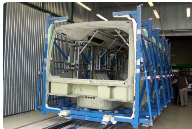
△ A kompozit buszok vázszerkezete nagy szilárdságú, könnyűszerkezetes, üvegszál technológiával megerősített műanyag elemekből készül.
