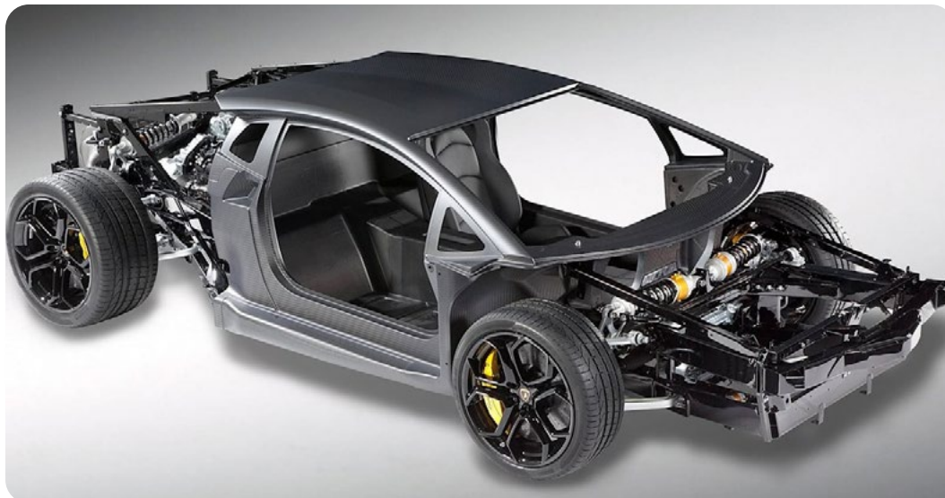
◁ A könnyűszerkezetes kompozit konstrukciók és alkatrészek forradalmasítják az autópárt.
