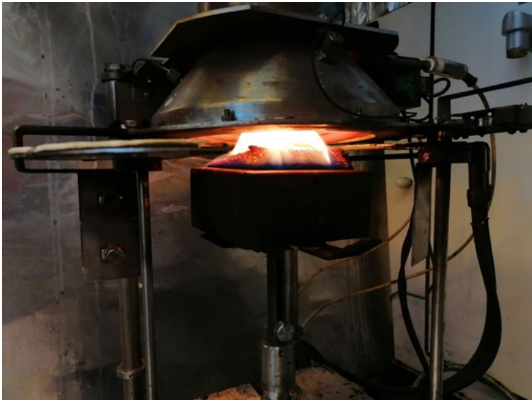
3. ábra: Tömegcsökkenésen alapuló kónikus kalorimetria
