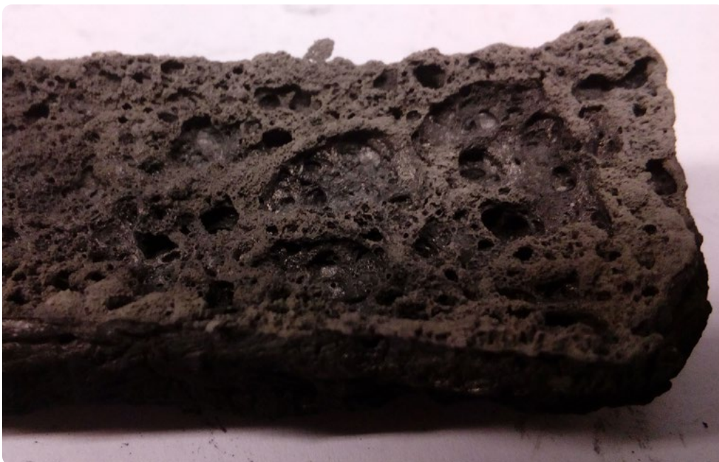
◁ 8. ábra: SG715 15%P APP bevonattal ellátott biztonsági öv csúszka mintadarab maradáknak habszerkezete a kalorimetriai vizsgálat után
