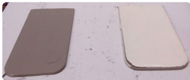
△ 1. ábra: Referencia és SG715 15%P APP bevonattal ellátott biztonsági öv csúszka mintadarab
