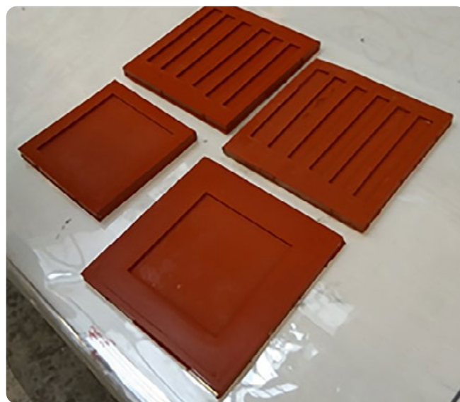
△ 2. ábra: Gélbevonatok öntéséhez használt szilikon szerszámok
