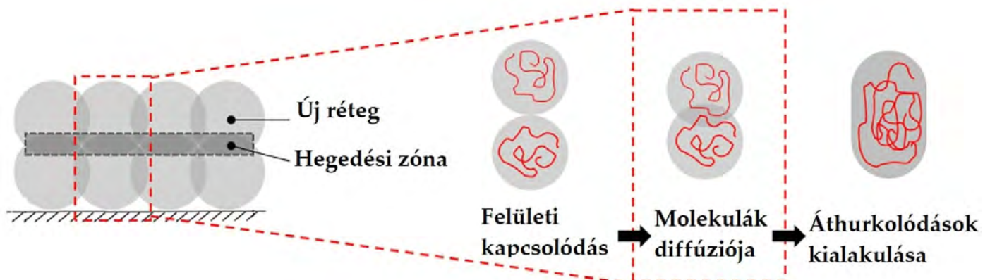
△ 2. ábra: A hegedés folyamata vázlatos ábrán [11]
