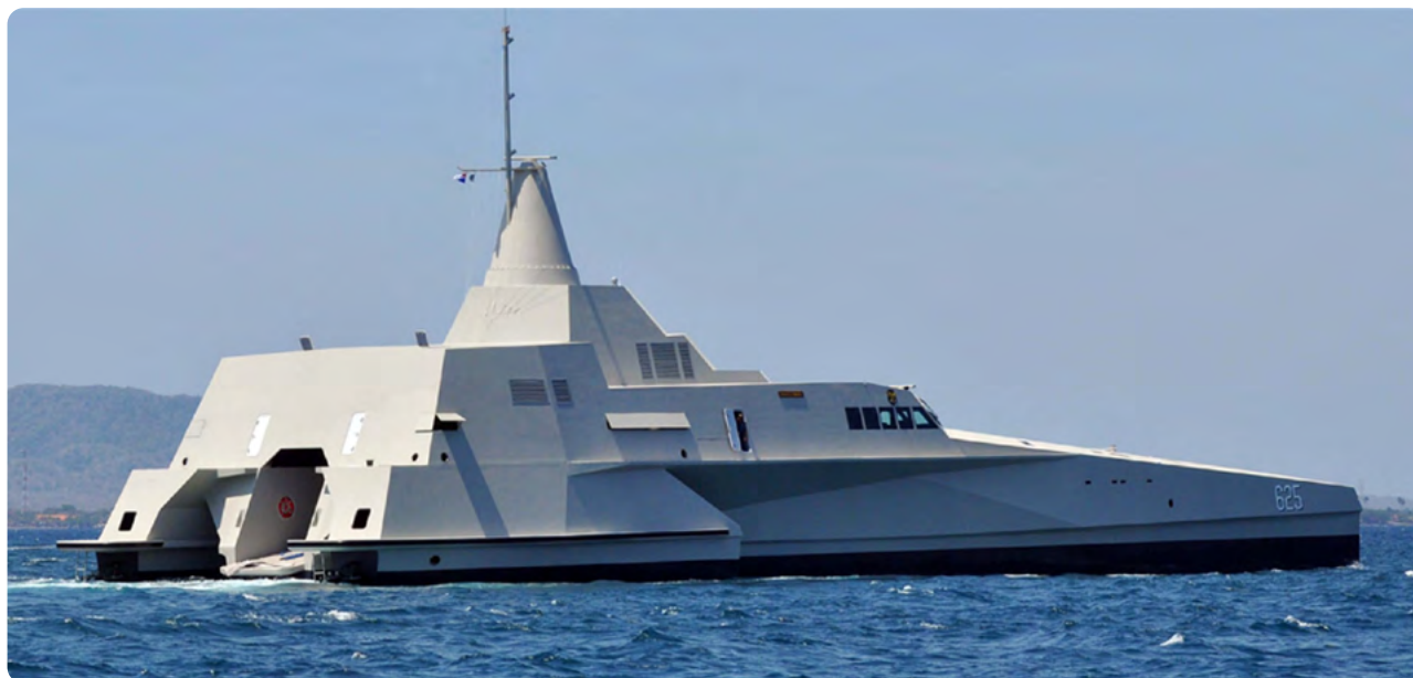
△ A legnagyobb kompozit hajó, a KRI Klewag 63 méter hosszú, szénszál és vinilészterrel módosított epoxi gyanta szendvicsszerkezetekből építették. Az indonéz haditengerészet lopakodó trimarán gyorstámadó járműve volt, felszerelése közben, 2012. szeptember 28-án tűz pusztította el.
