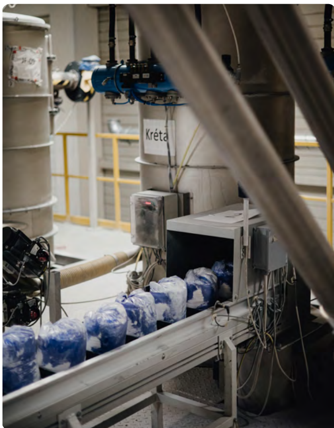
△ Teljesen automatizált, számítógép vezérelt alapanyagbemérő rendszer.
