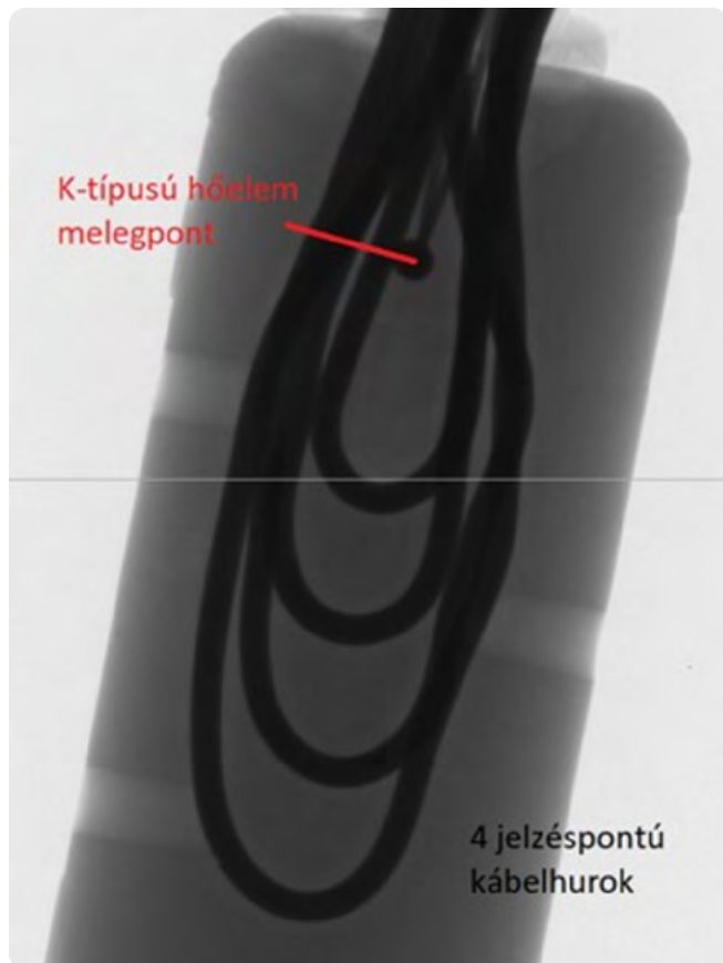
△ 9. ábra: A késztermék érzékelőjéről készített TRG felvétel.
